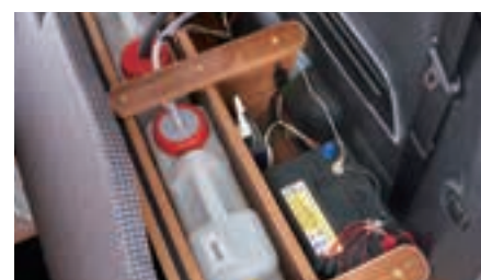
80Ahサブバッテリーシステムと給水及び排水タンク10Lを標準装備 右クォーターのベット下に格納。
