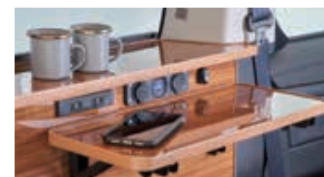
折り畳み式サイドテーブル 側面にはボルトメーター、100Vコンセント、USBポートに12Vシガーソケットを配置。
